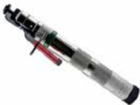
Abb 8: Penetrierender Bolzenschussapparat für Saugferkel: „Kleiner Blitz“
