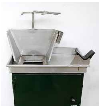
Abb 5: Kopfstütze zur Fixierung des Kopfes (rechts im Bild) sowie Vorrichtung zur Entblutung von Ferkeln
